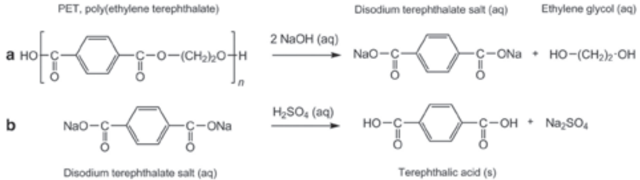
شکل ۱. a. هیدرولیز PET با NaOH به دی سدیم ترفتالات و اتیلن گلیکول. B تشکیل TPA از دی سدیم ترفتالات از طریق اسیدی کردن با سولفوریک اسید
